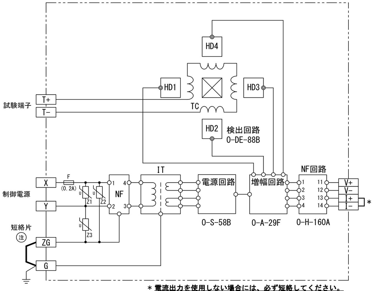
\* 電流出力を使用しない場合には、必ず短絡してください。
