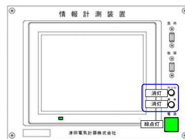
No. 3 (負荷計測部分の電源異常)
