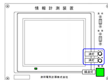
No. 3 (負荷計測部分の電源異常)
