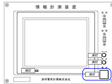
No. 2 (電源が供給されていない)
