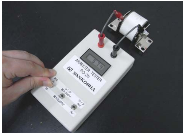
図7. 放電開始電圧の測定
