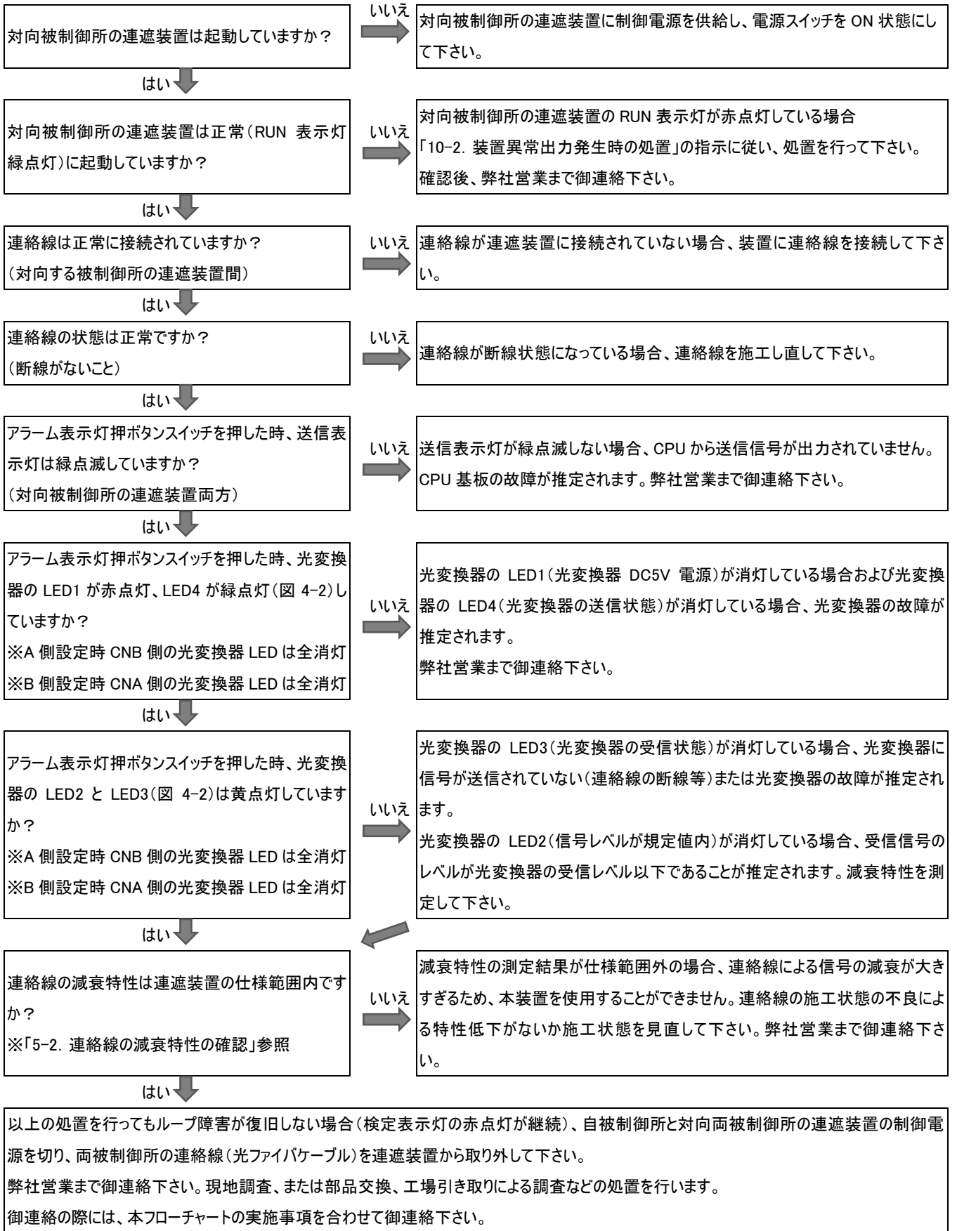
図 10-2. ループ障害発生時の処置
