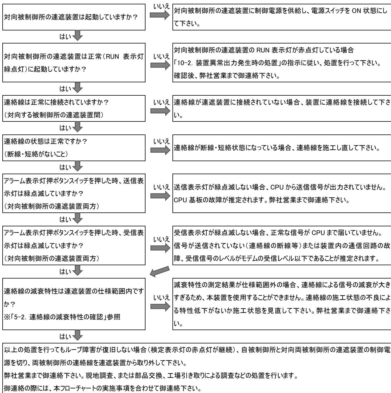
図 10-2. ループ障害発生時の処置
