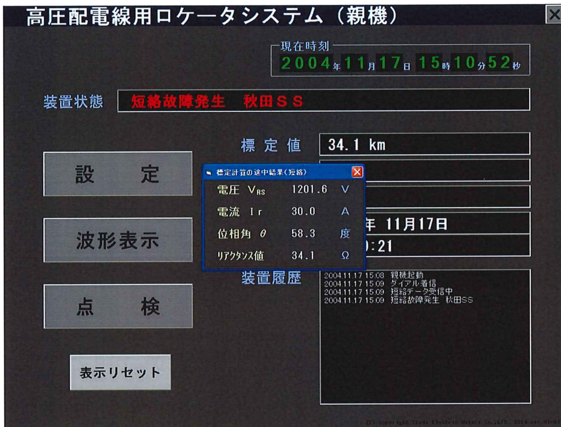
図 45. 短絡事故発生時の画面 2（データ収集装置）
