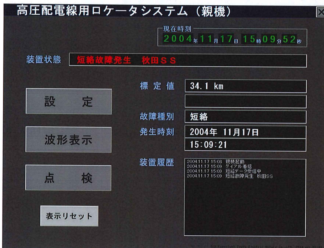
図 44. 短絡事故発生時の画面 1 (データ収集装置)
