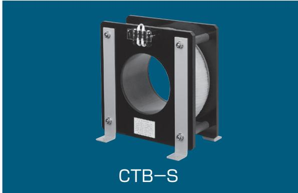
一次側の直流電流を二次側の交流補助電源を使用し交流電流へ変換することで、電流計測をします。貫通型となっており、一次側と二次側は絶縁されていますので取扱いが安全になります。一次電流の極性を判別する必要がある場合は極性検知巻線方式をお選びいただくことで、ご対応できます。
