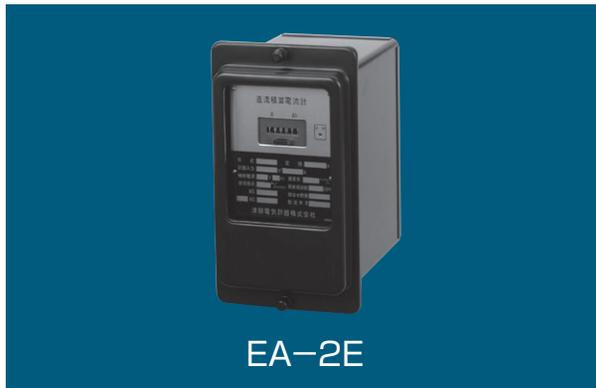
直流積算電流計(AH)は、直流電流を積算して電気量を表示するものです。直流電流を直流変流器などにより計測し、定格電流に対し1Vに変換して本装置へ入力します。
