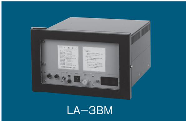
ATき電区間用の故障点標定装置です。故障点をはさむ2つのATに吸い上がる地絡電流が故障点距離に比例することを原理とした標定装置です。
